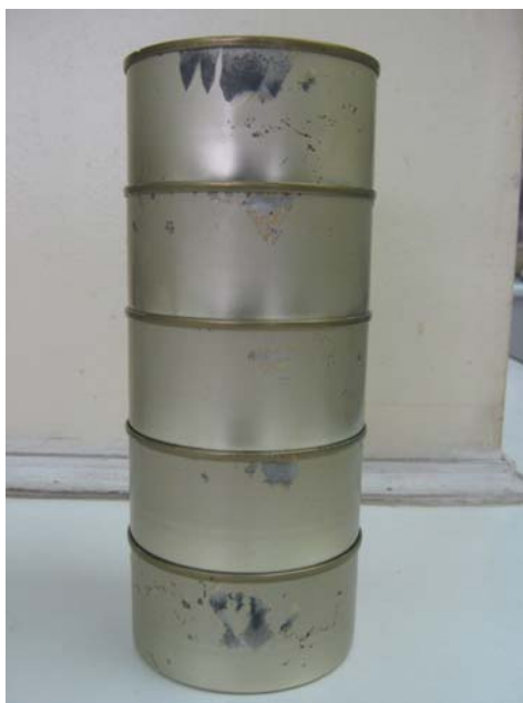
Fig. 1 Envases con fallas de barniz en la hojalata.
