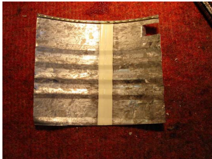
Fig 2. Zona de referencia toma de Muestras análisis, según protección plástica, con degradación superficial hojalata.
