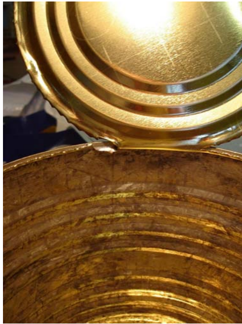
Fig 1. Apariencia interna envase con zonas degradadas y desestañado.
